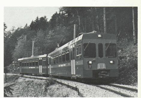
La première rame-navette, composée de l'automotrice Be 4/4 201 et de la voiture-pilote Bt 301, en service entre La Cure et Saint-Cergue. Elle représente l'unité de base pour les trains horaires. Grâce à leurs deux cabines de conduite, les automotrices peuvent aussi circuler seules. La possibilité de conduite en unités multiples par un seul agent, permet à un train comportant deux motrices et quatre voitures de transporter 896 personnes, dont 436 en places assises. (Photo BBC.)
