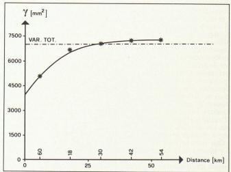
Fig. 8. – Variogramme brut des résidus des modules pluviométriques interannuels
