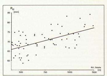
Fig. 6. — Régression altitude lissée sur une fenêtre de 12 × 3 km (ouest-est) — pluie journalière décennale.
