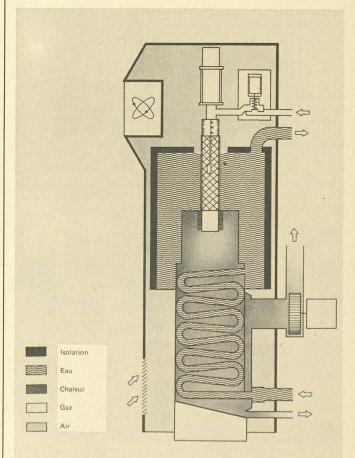
Le récupérateur-condenseur en acier inoxydable est entièrement intégré dans la chaudière à fuel léger du type «EMK» de la série «Ygnis-Rayol».
