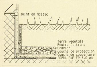
Le SOPRALÈNE EP 5.0 wh s'utilise pour former l'étanchéité sous les couches de terre. Il est constitué par des produits non attaquables par les racines pour assurer une sécurité supplémentaire.
