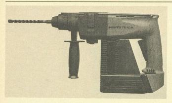
Le nouveau TE 10 A Hilti contenant un bloc accu 36 volts dispose d'une énorme capacité de charge : 100 trous pour chevilles Ø 6 mm ou de 50 trous pour chevilles Ø 8 mm. Secteur de perçage 5 à 16 mm.
