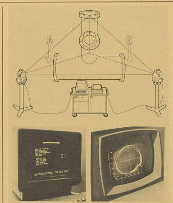
C'est ainsi que le système mobile RMS 2000 Wild-Leitz permet la vérification et la mesure sans contact direct des objets les plus disproportionnés: les théodolites informatiques T 2000 Wild sont mis en station autour de l'objet. Ils sont en configuration directe (on-line) avec l'ordinateur de table muni d'un écran graphique.
