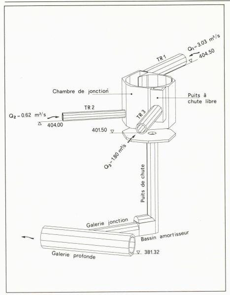
Fig. 11. - Coupe éclatée de l'ouvrage exécuté.
