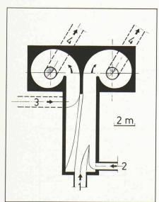
Fig. 2. - Variante: puits à vortex jumelés.
