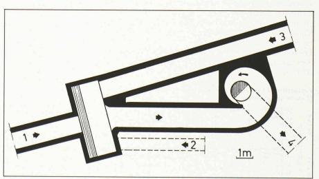
Fig. 3. - Variante: chambre de jonction et puits à vortex séparés.
