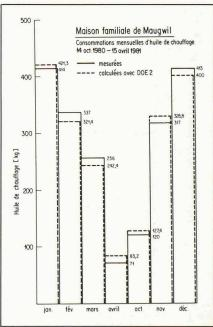
Fig. 5. — Comparaison entre calculs et mesures des consommations mensuelles d'huile de chauffage.
