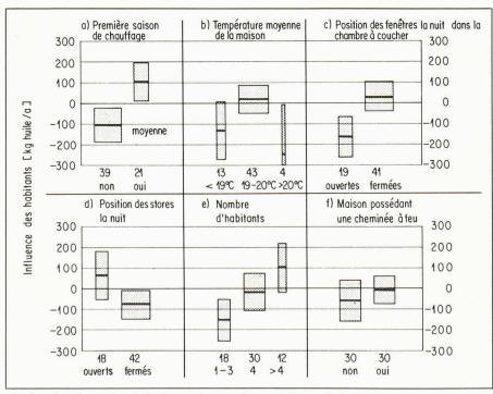
Fig. 8. — Représentation de l'influence de paramètres spécifiques des habitants sur la consommation d'énergie sur la base de six exemples ; les cas a) et c) montrent une dépendance significative, le cas f) l'absence de dépendance.
