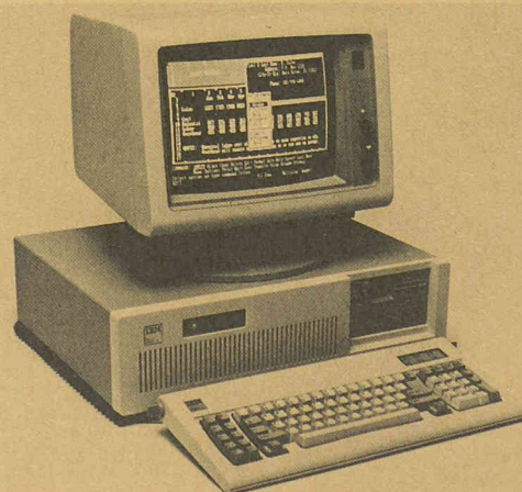
L'AT, le plus récent des ordinateurs personnels IBM, utilise un microprocesseur rapide et peut disposer de 3 millions de caractères de mémoire centrale à accès sélectif. Des dispositifs optionnels, un disque fixe nouveau de très grande capacité et une unité de minidisque supplémentaire, lui permettent d'atteindre une capacité de mémoire en ligne de 41,2 millions de caractères. Ce puissant système peut exécuter plusieurs programmes à la fois.
