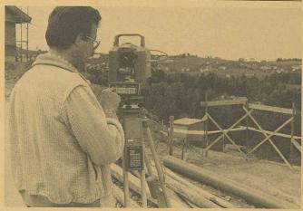
Le terminal de données électronique GRE3 Wild est utilisé avec succès sur les chantiers, même si les conditions ambiantes sont extrêmement sévères. Les calculs nécessaires aux adjudications et à la facturation, les calculs de statique, les cubatures ou les mesures et implantations faites au cordeau (photo) se font sur place avec le GRE3 Wild.
