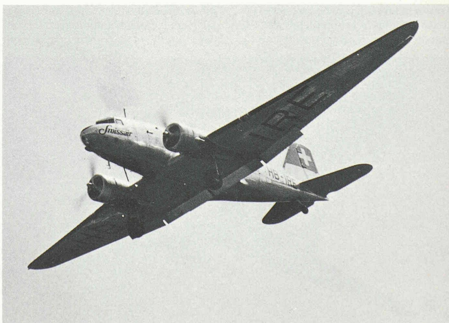
Un Douglas DC-3 de Swissair. Il s'agit là d'un avion acquis par notre compagnie nationale avant la guerre déjà, encore équipé de moteurs Wright Cyclone (9 cylindres en étoile) de 1000 ch, alors que les Dakota reconvertis en version civile (photo en fin d'article) avaient des Pratt & Whitney Twin Wasp (14 cylindres en double étoile) de 1200 ch.
