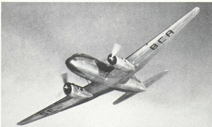
La fabrique suédoise SAAB – à l'origine exclusivement axée sur l'aéronautique – a également tenté sa chance en 1946 avec le «Scandia», emportant 32 passagers et équipé de deux moteurs de 1650 ch, pour remplacer le DC-3. Elle a connu un succès d'estime en Scandinavie et au Brésil, mais n'a pas réussi à s'imposer sur le marché, l'avion étant également trop petit.
