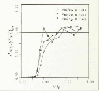
Fig. 7. Les spectres d'énergies normalisés par l'énergie moyenne dans l'intervalle  $f_p < f < 3f_p$  (partie arrière, pa) et la quatrième puissance de la fréquence, (f $^4$ S(f)) / (f $^4$ S(f))  $_{pa}$  vs. f/f $_p$ . Ils sont stratifiés par le paramètre, l'inverse de l'âge des vagues,  $u_{10}/c_o$ . Les données utilisées sont obtenues à la plate-forme fixe de Buchillon en 1984.
