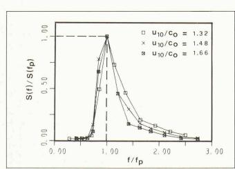
Fig. 6. Les spectres d'énergie normalisés par leurs composantes dominantes,  $S(f)/S(f_p)$  vs.  $f/f_p$ . Ils sont stratifiés par le paramètre, l'inverse de l'âge des vagues,  $u_{10}/c_o$ . Les données utilisées sont obtenues à la plate-forme fixe de Buchillon en 1984.
