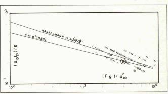
Fig. 4. Evolution de la fréquence  $f_p$  de la vague dominante en fonction du fetch F, et de la vitesse du vent  $u_{10}$ , sous la forme adimensionnelle, pour les données enregistrées à Buchillon. Elles sont comparées avec la relation de Hasselmann et al. (1973) et celle de SMB (1958). Le symbole (x) correspond au spectre d'énergie présenté dans la figure 3.
