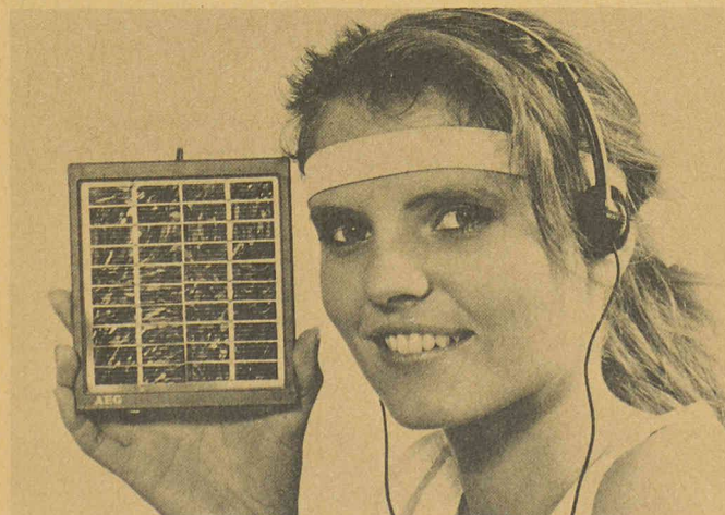
De la technologie allemande de pointe, l'entreprise AEG-Telefunken, avec notamment ses usines spécialisées de Berlin (Ouest) et de Francfort/Main, en livre par exemple dans le domaine de la technique solaire. Ce petit générateur solaire permet de faire fonctionner un «walkman». De la taille d'une carte postale, il permet d'éviter les achats répétés de piles.
