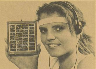
De la technologie allemande de pointe, l'entreprise AEG-Telefunken, avec notamment ses usines spécialisées de Berlin (Ouest) et de Francfort/Main, en livre par exemple dans le domaine de la technique solaire. Ce petit générateur solaire permet de faire fonctionner un «walkman». De la taille d'une carte postale, il permet d'éviter les achats répétés de piles.
