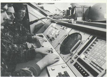
Dans le domaine de la défense contre avions (DCA), les systèmes d'identification «ami-ennemi» empêchent que la DCA ne tire sur ses propres avions par erreur; ainsi, lorsque les canons sont pointés sur ces derniers, les systèmes de contrôle interrompent automatiquement le tir.
