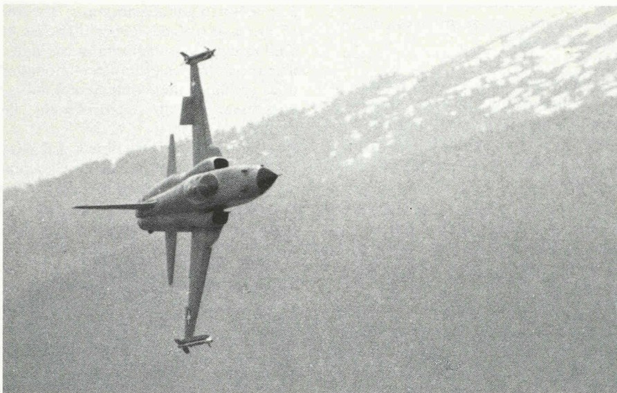
Le paradoxe de la technologie moderne appliquée au matériel militaire : le Northrop F-5E Tiger II de notre aviation militaire présente une meilleure disponibilité que ses prédécesseurs Hawker Hunter Mk. 58 ou De Havilland DH-112 Venom, grâce à une fiabilité accrue, mais le volume de travail requis par sa maintenance dépasse la capacité d'une troupe de milice en service pendant trois semaines.
