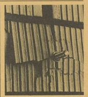
Essai d'arrachement dans la maconnerie creuse : la fixation résiste, la maconnerie éclate.
