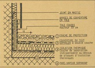
Schéma de la protection par Sopravap.
