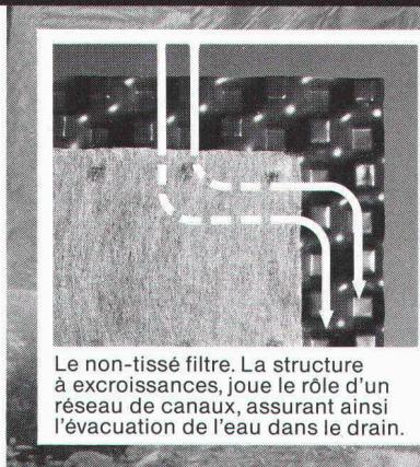
Le non-tissé filtre. La structure à excroissances, joue le rôle d'un réseau de canaux, assurant ainsi l'évacuation de l'eau dans le drain.
