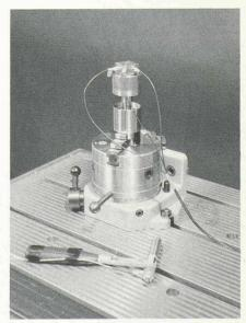
Fig. 6. Montage pour mesures dynamiques.
