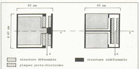
Fig. 3. Schémas de principe du capteur de forces.
