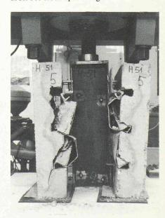
Fig. 2. — Essai «push-out». L'installation d'essais comprend un bâti de charge et un vérin hydraulique à servo-commande. L'éprouvette, qui repose sur les deux dallettes en béton, est mise en charge par application d'une force sur le profilé à l'aide du vérin.
