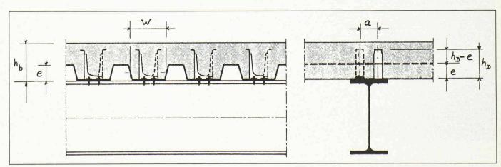
Fig. 6. — Poutre mixte acier-béton avec tôle profilée et deux rangées de connecteurs HVB disposés en sens opposé.
