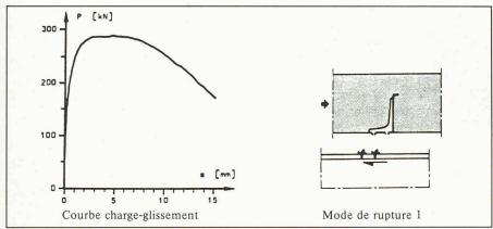
Fig. 3. - Comportement ductile.
