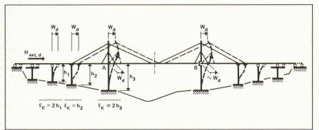
Fig. 8. – Etat de déformation à l'état-limite ultime d'instabilité.
