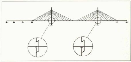
Fig. 4. - Modèle cadre plan.
