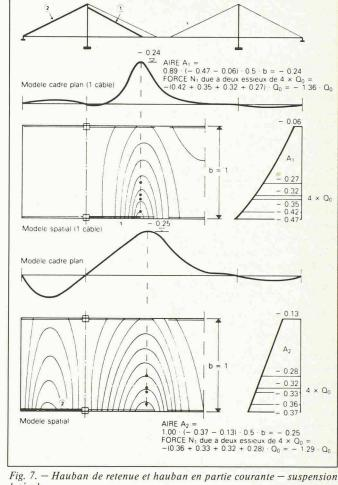
Comparaison entre la ligne d'influence de l'effort normal N calculée dans le modèle cadre plan et la surface d'influence calculée dans le modèle spa-
