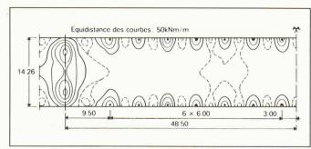
Fig. 11. - Modèle spatial, flexion longitudinale du tablier.
