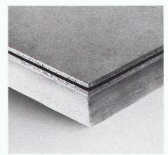
Les éléments isolants HOMISOL sont constitués d'un panneau de particules-support et d'une couche isolante en mousse de polyuréthane ou en laine de verre. Les panneaux HOMOGEN peuvent être obtenus dans les qualités Standard, hydrofuge ISO V100, ou ignifuge IG V100. La liaison rainure et languette garantit des surfaces planes continues.
