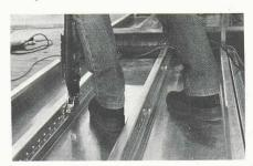
Fig. 2. — Déformation des panneaux à un niveau proche de la charge ultime.
