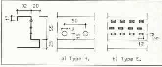
Fig. 7. — Connexion acier-béton: a) type H; b) type E.
