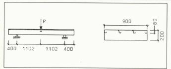
Fig. 6. - Schéma d'essai des séries 2H et 2E.
