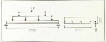
Fig. 5. — Schéma d'essai des séries 1H et 1E.
