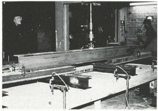
Fig. 10. - Essai de flexion en travée.
