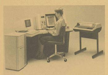
Le système de traitement de l'information Kodak Kar 2200 comprend (de gauche à droite): une unité centrale de traitement, un terminal d'ordinateur, un terminal micro-images Kodak IMT (ici, le modèle 150) et une imprimante papier, ainsi que le logiciel pilotant les recherches sur le terminal micro-images.
