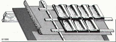
permet de réaliser des sous-toitures sans joints, étanches mais aussi perméables à la vapeur et pouvant respirer. Demandez prospectus et prix courant.
