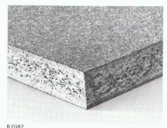
Les panneaux HOMOGEN ISO V100 sont résistants à la cuisson, perméables à la vapeur d'eau et constituent un volant de régulation pour l'humidité et le climat de l'habitat. Ils supportent de lourdes charges et peuvent dès lors être utilisés comme éléments de façades et cloisons de même que pour des sous-planchers et des plafonds. Demandez nos planches détaillées sur l'utilisation de l'HOMOGEN ISO V100. Appelez-nous.
