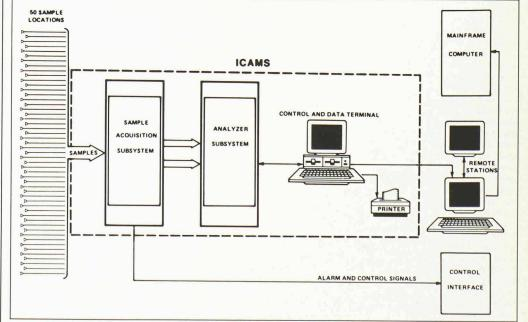
Schéma du système de détection chimique ICAMS.
