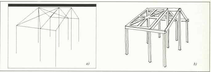
Fig. 10. Perspective d'une structure primaire en bois : a) maquette «fil de fer», logiciel Scribe ; b) matérialisation par esquisse manuelle.
