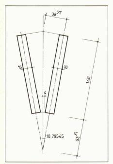
Fig. 13. Section composée des poutres maîtresses de la salle des congrès de Savigny.
