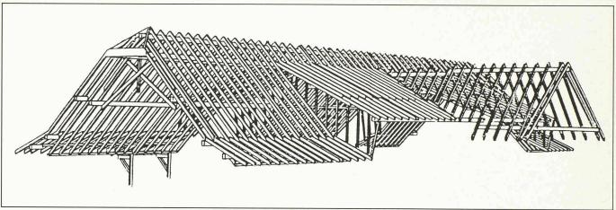
Fig. 4. Charpente de ferme vaudoise, relevé en vue d'une transformation. Dessin par ordinateur, logiciel Star; architecte: J.-Y. Evéquoz, Lausanne.
