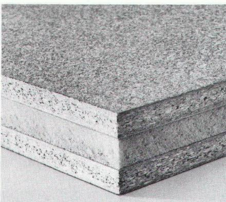
Les éléments HOMISOL DUO sont constitués de deux panneaux de particules collés sans formaldéhyde et d'une mousse intermédiaire de polyuréthane résistant à la compression. Ils sont résistants au trempage d'imprégnation et peuvent être surfacés, plaqués ou peints à volonté. La structure sans entretoise garantit un coefficient  $k$  uniforme de transmission de chaleur. Demandez nos planches détaillées sur les éléments et leur technique de fixation. Appelez-nous.
