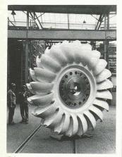
Roue motrice d'une turbine Pelton pour Cat Arm, Canada (70 MW, chute de 386 m), pareille à celles prévues pour Collierville.
