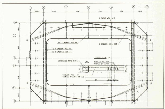
Fig. 6. — Dalle sur niveau 0 : schéma de la précontrainte.
