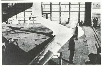
Fig. 7. — Le Linnet, avion à propulsion musculaire conçu par les japo-
