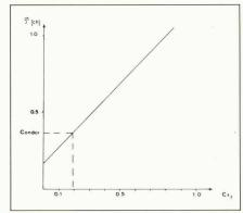
Fig. 10. — Puissance nécessaire au vol en fonction du  $C_x$  du fuselage  $C_{xf}$  pour le Condor.
