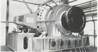
Dynamomètre hydraulique pour les essais finals de réception des grands moteurs diesel Sulzer (ci-dessus à droite). Photo d'usine Zöllner, Kjel.
