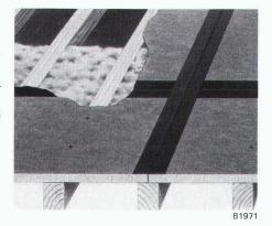
ISOROOF panneaux de sous-toiture sont réalisés en fibres de bois imprégnés de bitume. Grâce au système de sous-toiture ISOROOF complet – panneaux à assemblage rainure/languette, outillage approprié et accessoires – la mise en œuvre est à la fois rapide et sans problème. La solidité des panneaux garantit au couvreur une sécurité élevée. Demandez la documentation détaillée relative à ISOROOF système de soustoiture.
