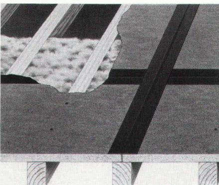
ISOROOF panneaux de sous-toiture sont réalisés en fibres de bois imprégnées de bitume. Grâce au système de sous-toiture ISOROOF complet – panneaux à assemblage rainure/languette, outillage approprié et accessoires – la mise en œuvre est à la fois rapide et sans problème. La solidité des panneaux garantit au couvreur une sécurité élevée.
