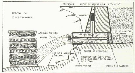
Schéma de fonctionnement du barrage.
