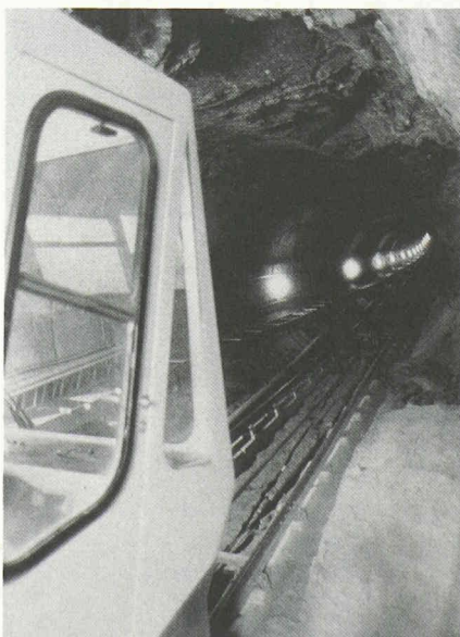
La ligne suit un tracé complexe, d'où de délicats problèmes pour le guidage du câble d'entraînement: 248 poulies!
