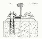
Sécurité et confort dépendent des fixations ; de gauche en bas, dans le sens de la montre : calcul des ancrages, vérifications de la résistance in situ, fixation de conduites et de câbles au moyen d'éléments Hilt, système d'attache de rail Vossloh.
