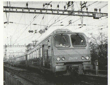
Si la ligne Les Eaux-Vives - Annemasse est bientôt électrifiée en 25 kV 50 Hz, elle verra circuler des rames automotrices doubles dites Z2 de la série 9501 (RABDe 4/8) pouvant circuler en rame de quatre éléments accouplés et télécommandés. L'attelage automatique permet facilement de former un multiple d'éléments doubles, ce qui permettra de former depuis Les Eaux-Vives des circulations directes pour Evian et Saint-Gervais selon la formule des trains éclatés. Une rame de trois éléments Lyon - Genève à Genève en mars 1983. La puissance est de 1200 kW par machine et la V max en service de 160 km/h. (Photo R. Kallmann.)
