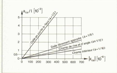
Fig. 8. — Flèche a<sub>cs</sub> due au retrait pour une dalle fissurée, approximativement valable pour des planchers sur appuis linéaires ou sur colonnes.
