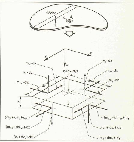
Fig. 1. – Elément infinitésimal et bande d'une dalle.
