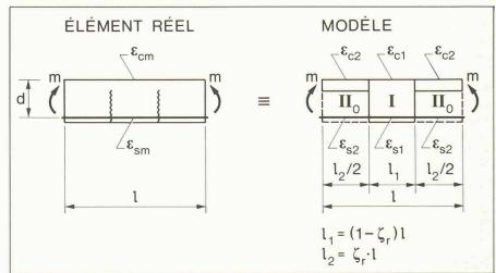
Fig. 3. — Modèle pour le calcul de la courbure.
