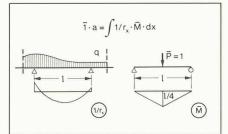
Fig. 2. – Courbure réelle et moment virtuel.
