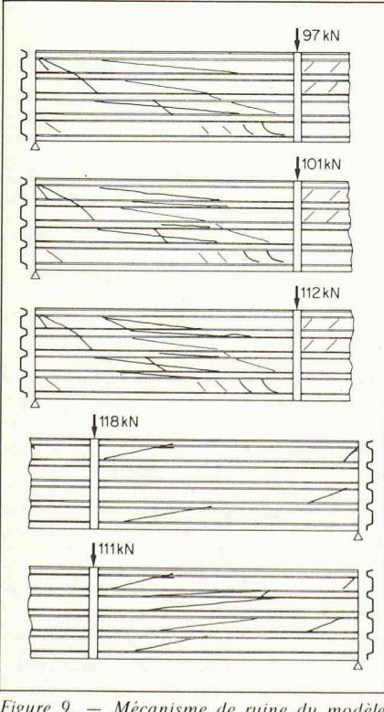
Figure 9. — Mécanisme de ruine du modèle n° 3.
