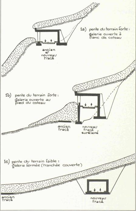
Fig. 1. — Choix du type de galerie en fonction de la topographie : la) pente du terrain forte, galerie ouverte à flanc de coteau ; lb) pente du terrain forte, galerie ouverte à pied de coteau ; lc) pente du terrain faible.
