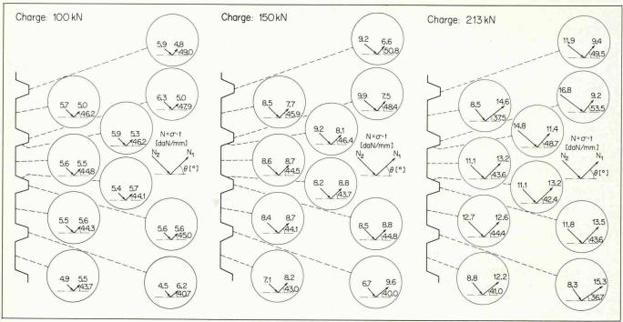
Figure 7. – Contraintes dans les axes principaux sous différentes charges (modèle nº 1).
