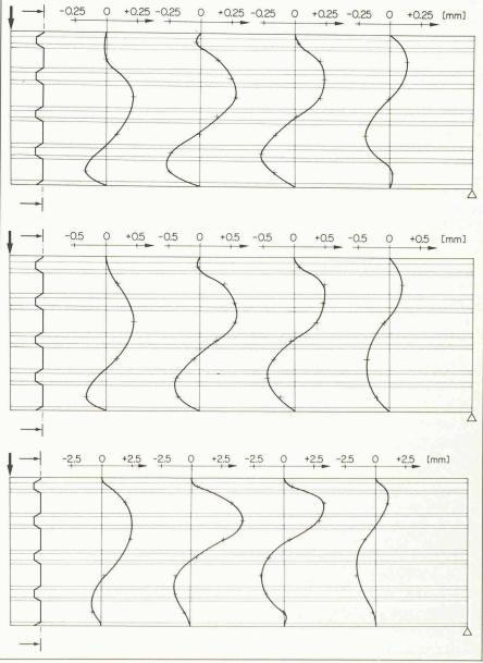
Figure 4. — Déformée transversale de l'âme du modèle nº 1 sous différentes charges : a) 100 kN b) 150 kN c) 213 kN.
