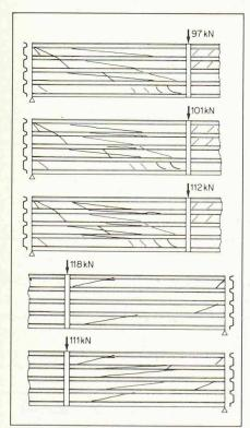
Figure 9. - Mécanisme de ruine du modèle nº 3.
