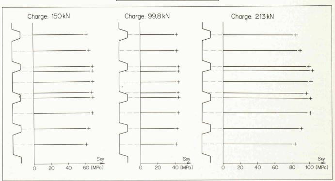
Figure 6. — Distribution des contraintes de cisaillement sur la hauteur de l'âme du modèle nº 1 sous différentes charges.
