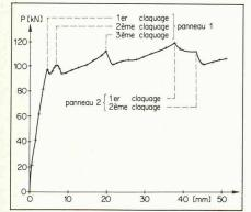
Figure 8. - Evolution de la flèche centrale au niveau de l'âme du modèle nº 3.
