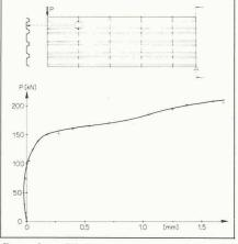
Figure 3. — Déplacement transversal au point indiqué (diagramme pour le modèle nº 1).
