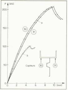
Figure 2. — Flèche au centre dans le plan de la section droite médiane : courbes a) modèle nº 1: t = 1,25 mm; courbes b) modèles nº 2 et nº 3: t = 0,85 mm.
