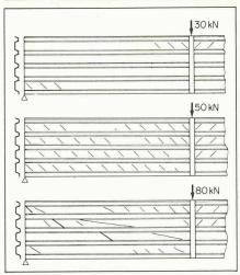
Figure 5. — Mode d'instabilité locale du modèle nº 3 sous différentes charges.
