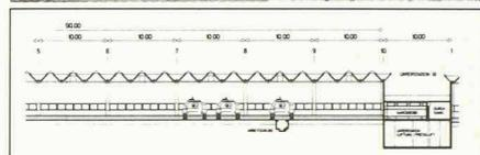
Vaste complexe préfabriqué avec disposition spatiale triangulaire composé de halles respectivement de 60 et 90 m de longueur
