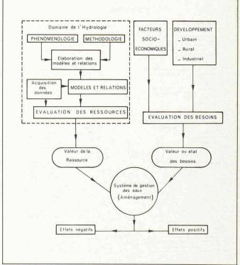
Fig. 2. - Place de l'hydrologie dans l'aménagement des eaux.
