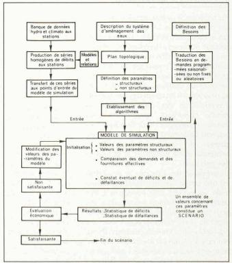
Fig. 7. — Un exemple général d'application à un aménagement/technique de simulation.
