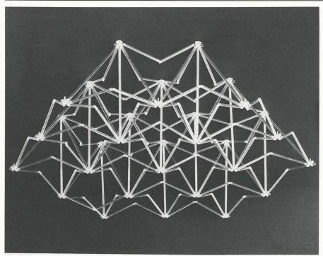
Fig. 2. - Structure expansible dans un état intermédiaire.
