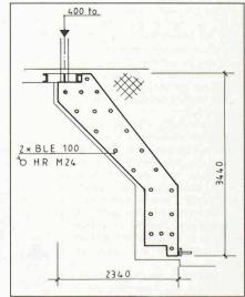
Fig. 13. - Béquille inclinée à section pleine.
