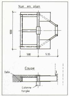
Fig. 6. — Tête de poinçonnement sur pilier de façade.
