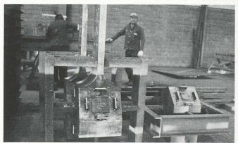
Fig. 4. — Tête de poinçonnement avec noyau forgé et tirant.
