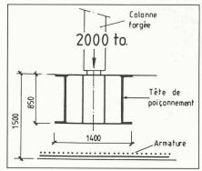
Fig. 1. — Tête de poinçonnement avec noyau forgé.
