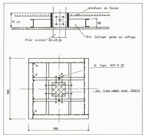
Fig. 12. - Accrochage de dalle sur pilier existant.
