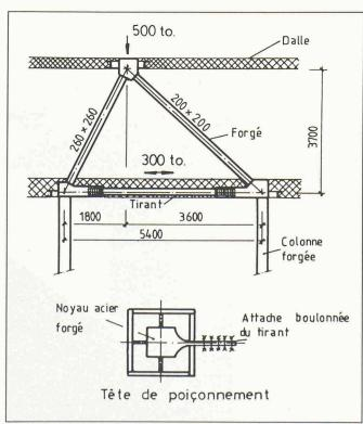
Fig. 2. — Déviation d'une charge ponctuelle de 500 tonnes.
