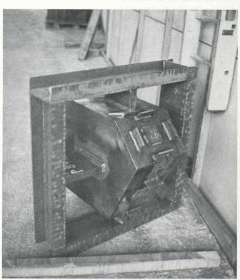
Fig. 3. — Tête de poinçonnement posée sur des colonnes obliques.
