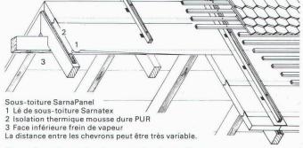
SarnaPanel pour les travaux de rénovation.
