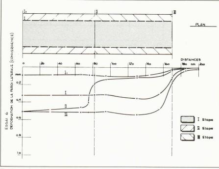
Fig. 8. - Convergences horizontales calculées: essai 6.
