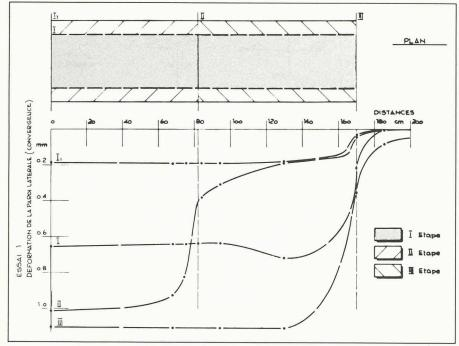
Fig. 7. — Convergences horizontales calculées: essai 1.
