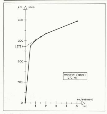
Fig. 14. — Détermination de la réaction d'appui.
