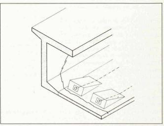
Fig. 7. - Fissure d'entraînement.
