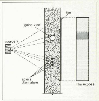
Fig. 18. - Principe de la gammagraphie.
