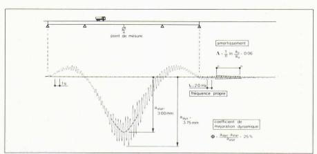
Fig. 12. — Vibrations d'un pont au passage d'un camion et détermination des caractéristiques dynamiques.
