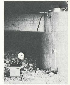
Fig. 13. - Soulèvement d'appui.
