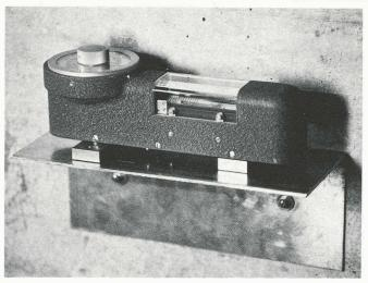
Fig. 10. – Clinomètre mécanique (à nivelle).
