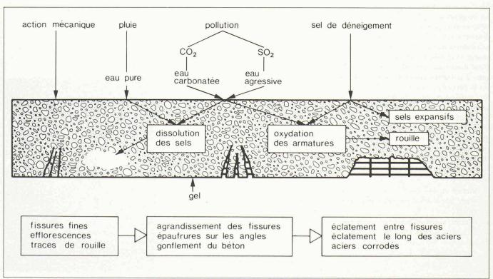
Fig. 3. - Evolution de la dégradation du béton.
