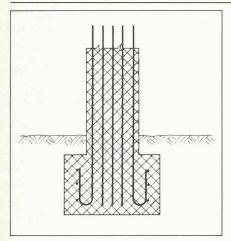
Fig. 3. - Ancrage dans le sol.
