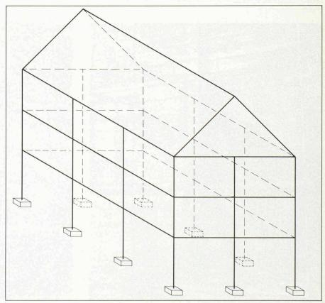
Fig. 2. — Schéma du corset de protection anti-sismique.
