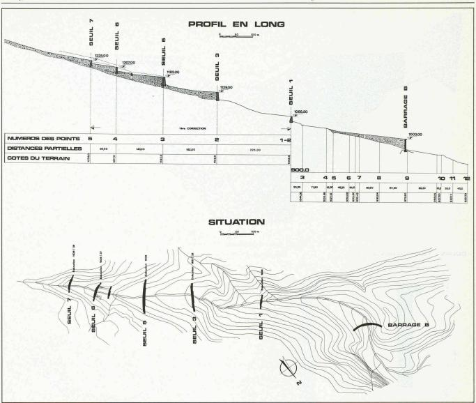
Fig. 19. — Situation et profil en long montrant l'emplacement du barrage par rapport à la première correction.
