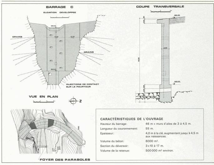
Fig. 23. — Caractéristiques techniques du barrage C, parabolique.
