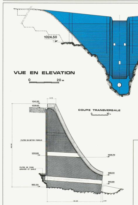
Fig. 14. – Caractéristiques techniques du barrage de l'Illgraben.
