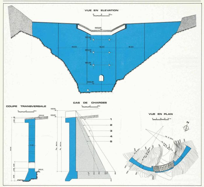
Fig. 21. — Caractéristiques techniques du barrage B, cylindrique.
