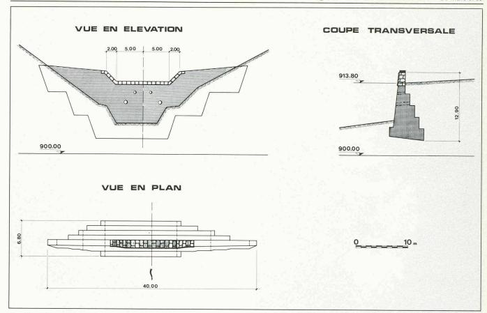
Fig. 10. - Plans d'un seuil classique en béton.
