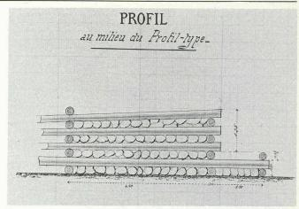
Fig. 6. - Coupe en travers du même seuil de la fig. 4.
