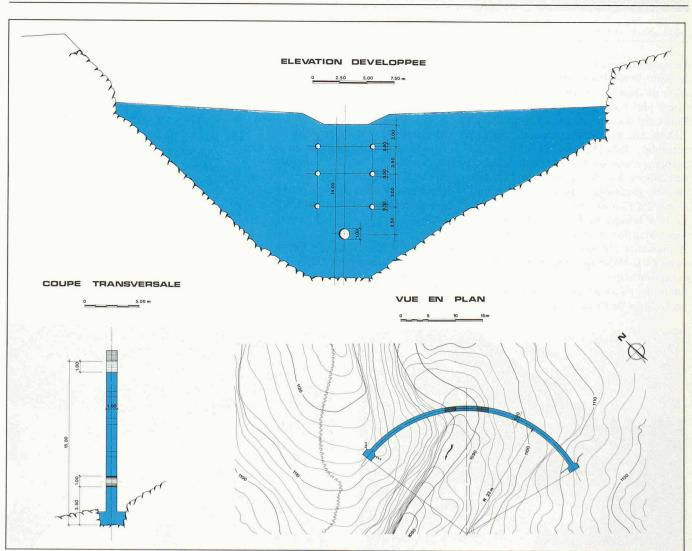
Fig. 11. — Caractèristiques de seuils arqués en béton utilisés sur le Merdenson.
