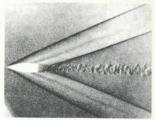
Fig. 1. — Photo strioscopique pour M > 1.
