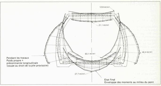
Fig. 14. - Moments transversaux sur le pont.
