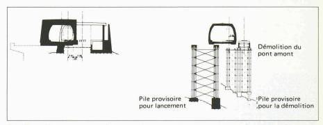
Fig. 12. — Mise en service après le second ripage, coupes en travers: sur l'appui côté Göschenen (à gauche) et dans la portée (à droite).
