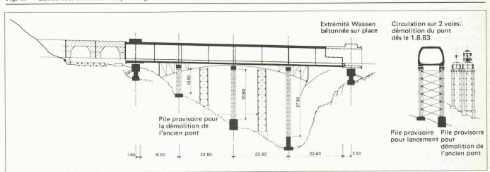
Fig. 7. - Lancement, phase finale: coupes longitudinale et transversale.
