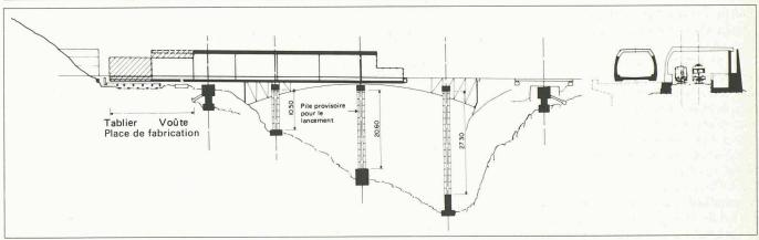
Fig. 6. - Lancement en cours : coupes longitudinale et transversale.
