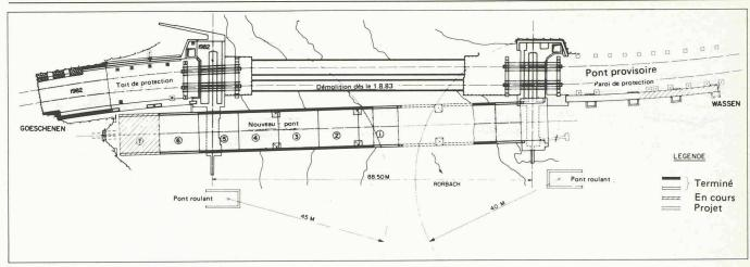
Fig. 5. - Phases du lancement: vue en plan.
