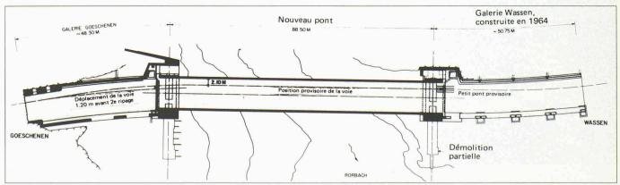
Fig. 13. – Mise en service après le second ripage: vue en plan.
